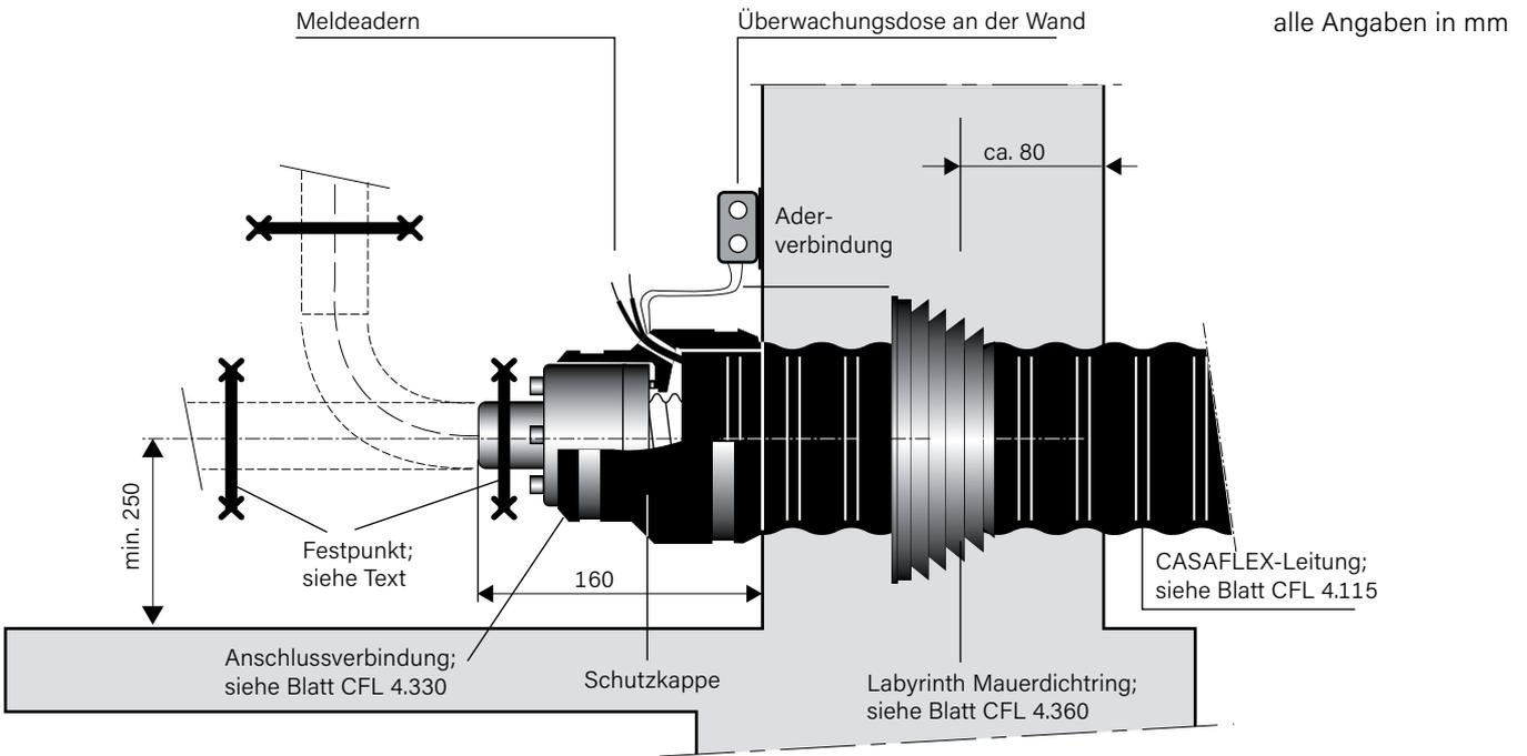
Die Anschlussverbindung resp. die CASAFLEX-Leitung ist nicht geeignet um Dehnungen der weitergehenden Leitung aufzunehmen. Aus diesem Grund ist eine Festpunktschelle zu montieren (siehe Arb.-Blatt CFL 4.515).
