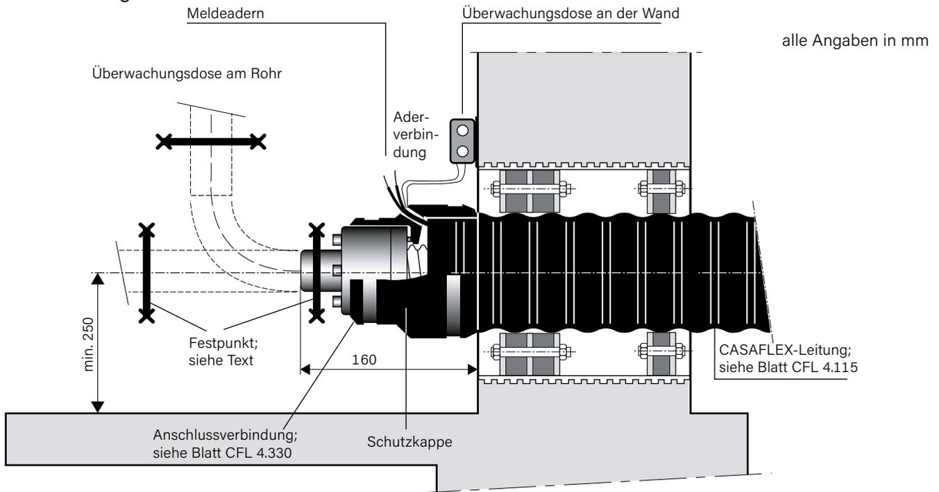
Die Anschlussverbindung resp. die CASAFLEX-Leitung ist nicht geeignet um Dehnungen der weitergehenden Leitung aufzunehmen. Aus diesem Grund ist eine Festpunktschelle zu montieren (siehe Arb.-Blatt CFL 4.515).
