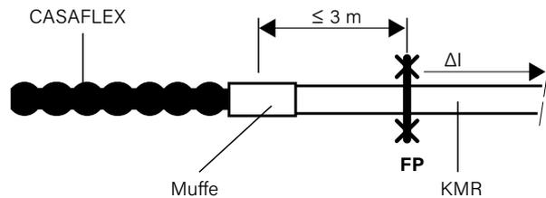
Die Ausdehnung  $\Delta l$  des KMR, infolge Temperaturerhöhung, darf nicht von den CASAFLEX-Leitungen kompensiert werden. Einbau eines Festpunktes erforderlich.
