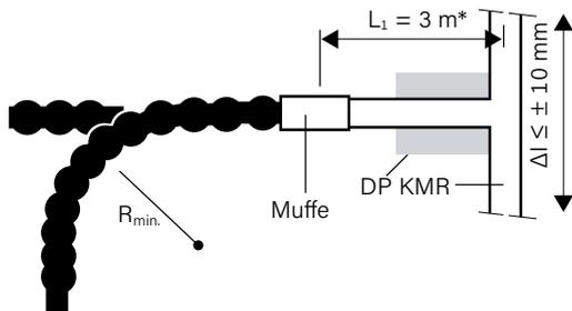
Die Querdehnung  $\Delta l$  darf nur soviel betragen, dass die Dehnung durch den Abgang DS und der CASAFLEX-Leitungen aufgenommen werden kann.
