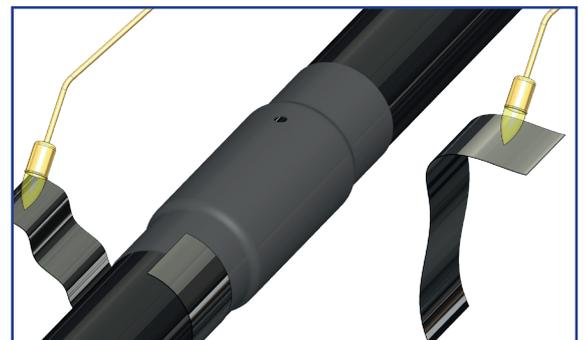
**DE Montageablauf****EN Installation process****15****DE Schrumpfmanschette schließen**
